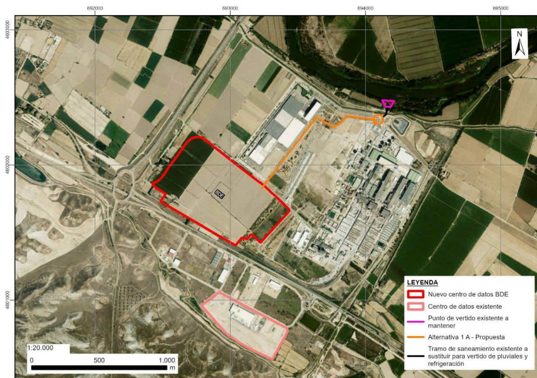
Figura 4.2-13: Propuesta de vertido de aguas pluviales y de refrigeración. Alternativa AVP+R1A. Vertido a la arqueta de reunión de caudales del P.I. El Espartal. Trazado a través del vial al este. Fuente: AECOM, 2024.
